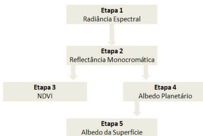
Figura 3 - Diagrama de etapas do Processamento do Índice de Vegetação da Diferença Normalizada (IVDN) e do albedo da superfície.
