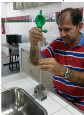
Figura 1: Calibração do pluviógrafo desenvolvido
