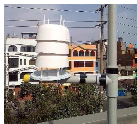
Figura3: Sensor de temperatura y humedad dentro de su protección contra la radiación. Prototipo Costa1
