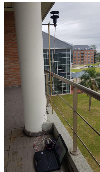
Figura 3 - Ensayos en exteriores y puesta en marcha del anemómetro.
